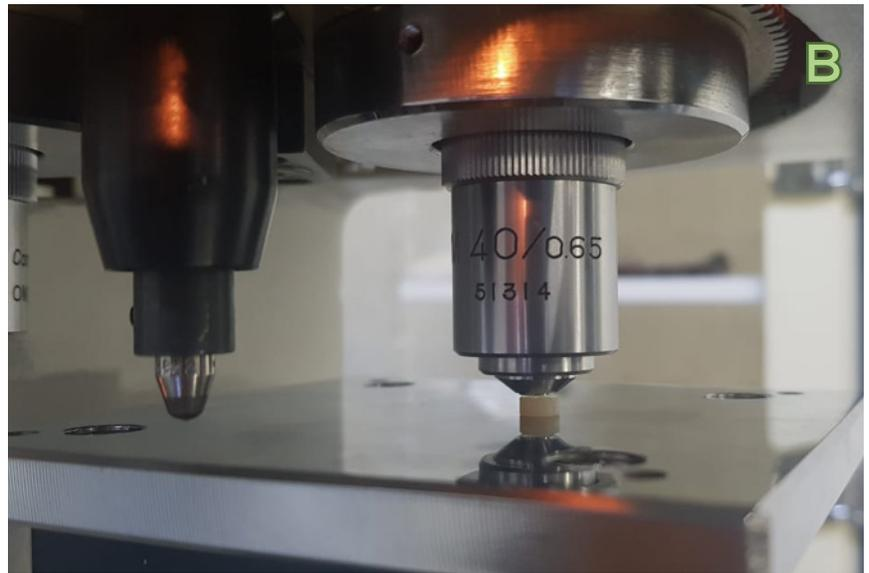
Figura 4. A) Microdurómetro (INDENTEC ZHV®, Zwick/Roell Indentec). B) Microindentador.
