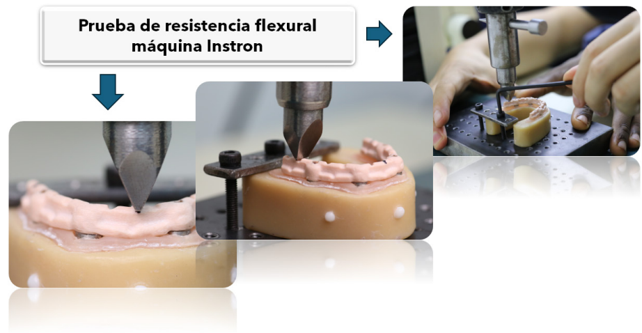
Figura 4. Pruebas de resistencia flexural maquina Instron Marca Tinius Olsen, Modelo H50KS.
