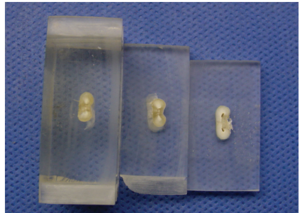
Figura 2 Cortes en tres tercios embebidos en resina epóxica.
