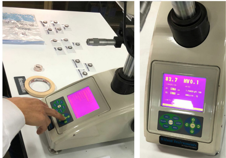
Figura 3. Microdurómetro en el que se realizaron las microindentaciones
