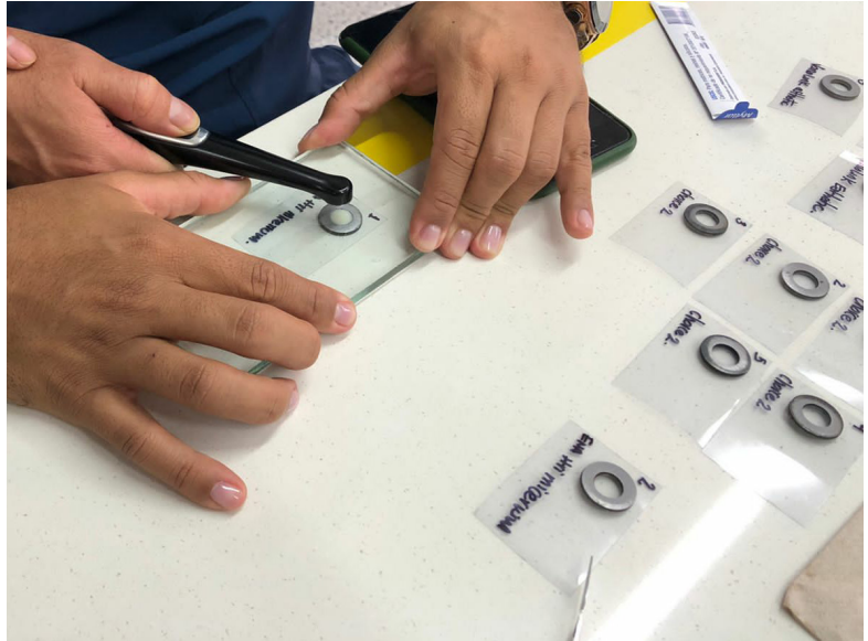
Figura 2. Polimerización de cada cemento incluido en el molde
